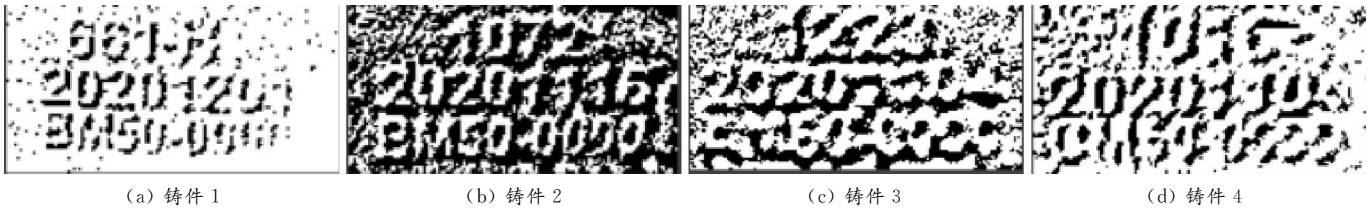
图 13 提取后二值化处理效果图 Fig.13 Binarization effect after extraction
