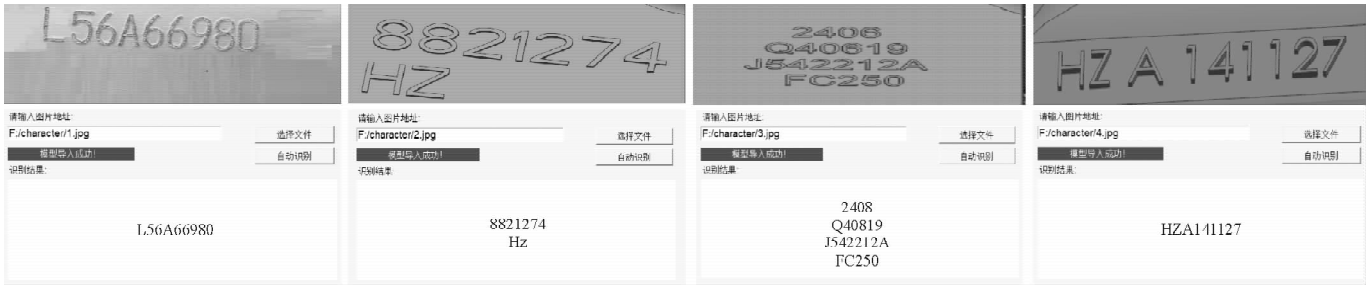
(a) 铸字表面较粗糙 (b) 铸字整体倾斜 (c) 铸字多行分步 (d) 铸件结构干扰
